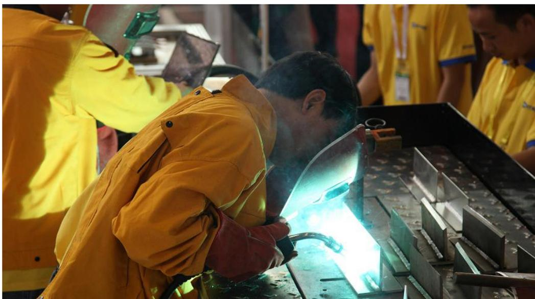
CO<sub>2</sub>气体保护焊是 50 年代发展起来的一种新的焊接技术。半个世纪以来，它已发展成为一种重要的熔焊方法。广泛应用于汽车工业，工程机械制造业，造船业，机车制造业，电梯制造业，锅炉压力容器制造业，各种金属结构和金属加工机械的生产。
