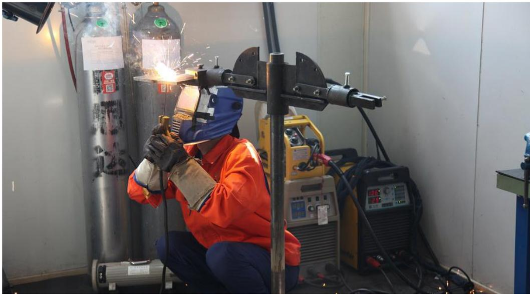
焊接设备是实现焊接工艺所必不可少的装备，每一个从事焊接工作的企业或个人都希望充分发挥设备的性能，延长机器的使用寿命。要达到这个目的，除了按操作规程正确使用焊接设备外，还要定期做好保养与维修的工作。焊接设备包括焊机、焊接工艺装备和焊接辅助器具，下面分别对焊枪、送丝装置及焊机的养护要点逐一进行说明。
