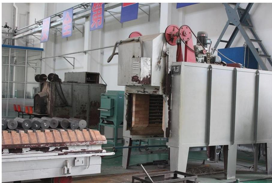
不锈钢管热处理国外普遍采用带保护气体的无氧化连续热处理炉，进行生产过程中的中间热处理和最终的成品热处理，由于可以获得无氧化的光亮表面，从而取消了传统的酸洗工序。这一热处理工艺的采用，既改善了钢管的质量，又克服了酸洗对环境的污染。
