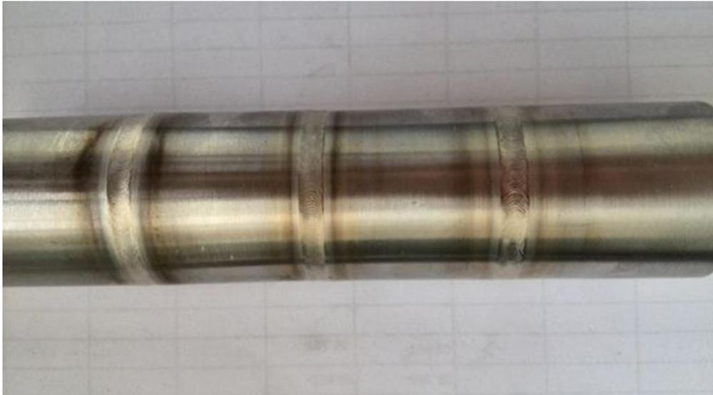
TIG 焊在生产中已经得到广泛的应用，它可以获得优质焊缝，常用来焊接有色金属、不锈钢、超高强度钢等材料。但是 TIG 焊存在熔深浅( $\leq 3\text{mm}$ )、焊接效率低等缺点，对于厚板需要开坡口进行多道焊。增大焊接电流虽然能使熔深增加，但熔宽和熔池体积增加的幅度要远大于熔深的增加幅度。
