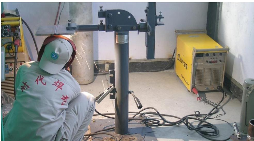
焊接性指同质材料或异质材料在制造工艺条件下，能够焊接形成完整接头并满足预期使用要求的能力，材料、设计、工艺及服役环境为影响焊接性的四大因素。评定焊接性的原则主要包括：①评定焊接接头产生工艺缺陷的倾向，为制定合理焊接工艺提供依据；②评定焊接接头能否满足结构使用性能的要求。
