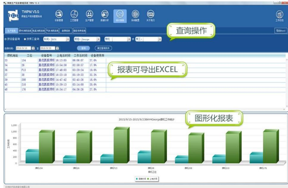
使用 TWPM 系统，您不仅可以查询焊工工作报表、设备工作报表、焊材消耗报表、电能消耗报表、气体消耗报表、设备故障报表、维修保养报表等信息，而且还可以导出 EXCEL 文件，更有图形化展示哟！
