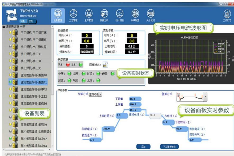
使用 TWPM 系统，您不再需要频繁奔波，足不出户即可轻松查看车间所有设备工作状态，更为方便的是您还可以查看每台设备的细节状态，例如：当前焊工使用的工艺参数；焊接过程中的电流、电压波形图；出现故障的具体信息等。
