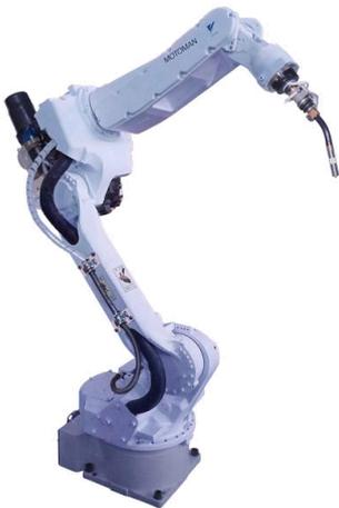
MA1400 机器人本体是专门为焊接工业设计的机器人。除了具有和其他机器人共有的基本功能之外，该机器人本体采用内置电缆式设计，送丝电缆，保护气体管线，冷却管线都集成在机器人内部，这样可以有效的避免干涉，提高机器人的可达性能。
