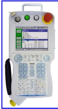
机器人示教编程器如右图所示，它是机器人人机互动的主要界面，集成了通用工业控制按键和按钮，同时按照人机工程学最优化的原则配置各类操作按钮并控制编制输入格式。除了密码控制操作权限之外，还有硬件锁。嵌入式 WIN7 系统，支持多任务，多窗口，使编程和监视可以交互操作，有效的提高了编程效率。彩色触摸显示屏。中英日三种可选语言。INFORM III 程序语言，使用集成式命令，可以定制宏命令。
