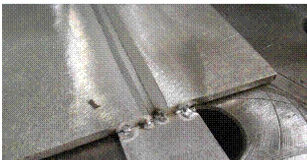
6. 点固焊后，再次用不锈钢丝刷清理点固焊的表面氧化膜；再次用丙酮、无尘布擦拭待
