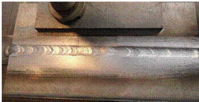
11. 焊接表面焊缝，焊后用不锈钢丝刷去除表面氧化膜。
