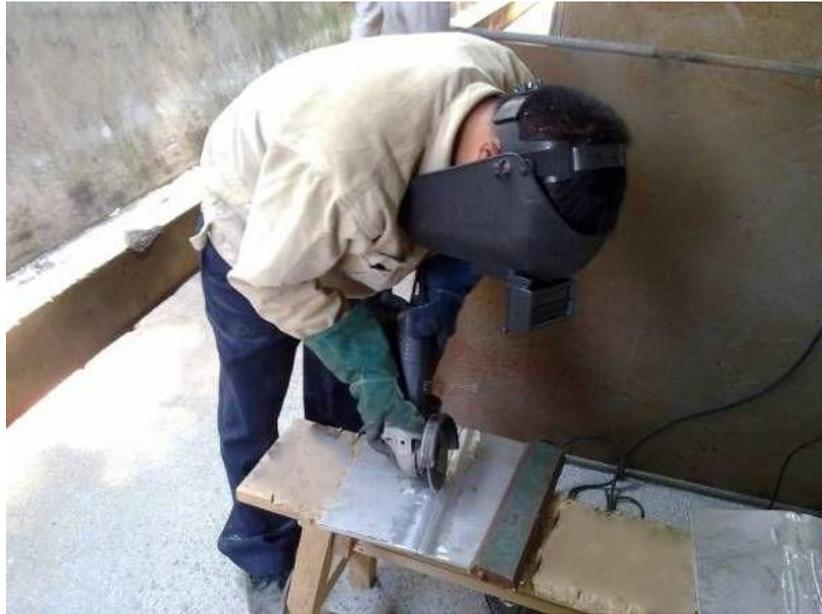
14. 铝合金焊丝因为真空冶炼技术和焊丝拉拔技术的差异，国产铝合金焊丝几乎全有气孔，一般不能用于无损探伤的铝结构件上；有探伤要求的，最好用进口铝合金焊丝。
