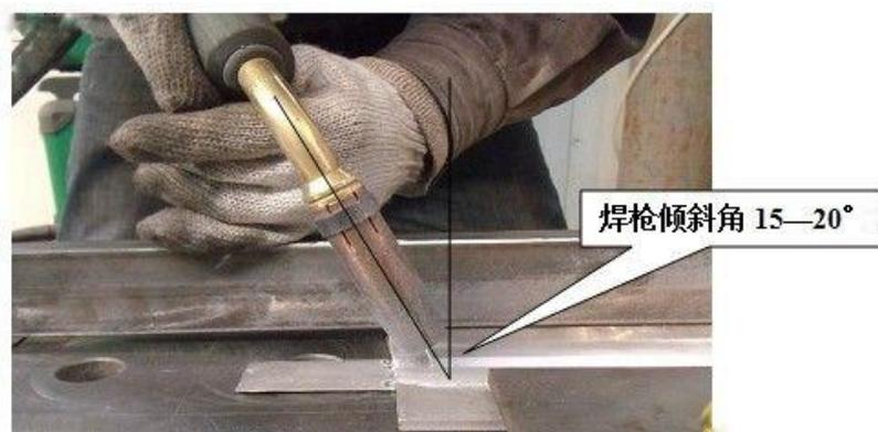
10. 焊接完第一道焊缝，用不锈钢丝刷去除表面氧化膜，再用丙酮擦拭干净。
