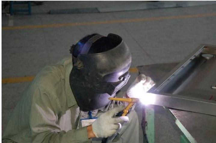
氩弧焊是以惰性气体“氩气”作为保护气体的一种电弧焊方法，氩气从喷嘴喷出，在焊接区形成惰性气体保护层，隔绝了空气的侵入，从而对电弧及熔池形成保护。但由于氩弧焊抗风能力弱，对铁锈、水、油污特别敏感，对气体纯度、坡口清理、焊接工艺等要求严格，容易产生气孔。本文结合实际对氩弧焊焊接产生气孔问题进行分析，并提出一些解决方法。
